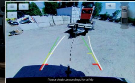
**CÁMARA DE REVERSA CON ASISTENCIA DINÁMICA PARA ENGANCHE DE REMOLQUE**
