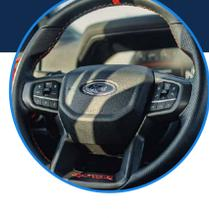
Levas al volante de magnesio de alta calidad, permitiendo al conductor poder hacer cambios rápidamente sin levantar las manos del volante.
