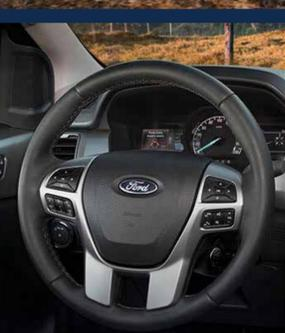
El volante multifunción de la Nueva Ranger XLT tiene tres conjuntos de comandos a través de los cuales se pueden controlar varias funciones del vehículo, incluyendo el computador a bordo, la velocidad cruceo y el sistema de conectividad SYNC 3® sin levantar las manos del volante.
