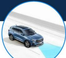
Conoce la Tecnología de Control de Crucero Adaptativo con Asistencia de Colisión Frontal con Ayuda de Frenado equipada en el SUV Ford Territory Trend, capaz de ajustar automáticamente la velocidad en relación a otros vehículos y entorno, mediante radares y cámaras.
